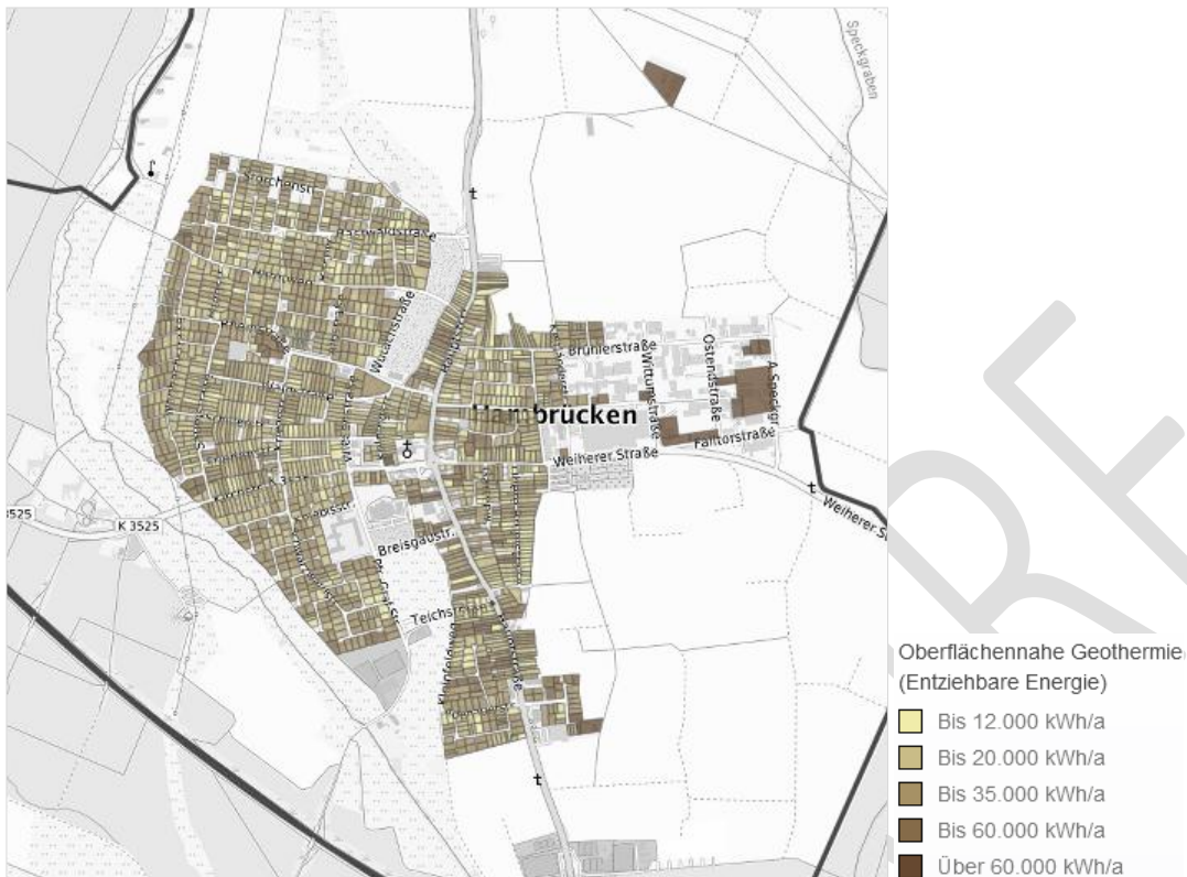
Abbildung 21: Räumliche Verortung des theoretischen Maximalpotenzials zur Nutzung von Erdwärmesonden (KEA-BW, 2022a)
